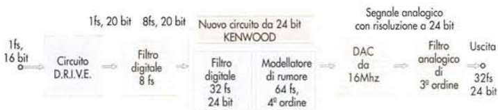
● Schema a blocchi del Convertitore D/A a 24 bit
