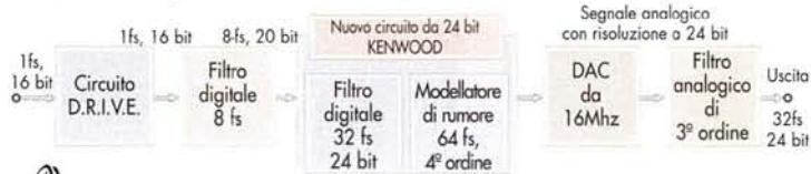
● SCHEMA A BLOCCHI DEL FINE D.R.I.V.E. a 24 bit
